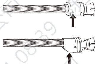
保险入水管: 应定期检查安全阀检窗口(见箭头): 如呈红色, 说明安全阀已经启用, 此时必须更换水管。按下释放按钮(如有), 或拧开软管。
