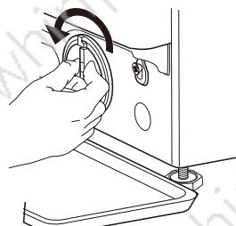
6. 插入滤网塞并装回底座：将滤网塞回原位，然后按顺时针方向转紧到最深位置。滤网手柄必须处于垂直位置。可以倒入约1升的水于洗涤盒测试滤网是否已转紧。然后装回底座。
