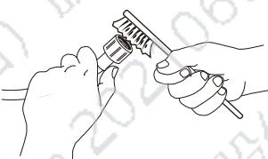
3. 拆下洗衣机后方的进水管。用通用钳子将滤网从洗衣机接头上拆下并清洁。
