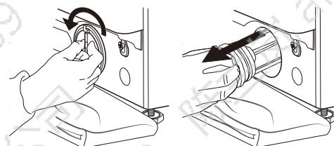
2. 放置一个容器：将宽阔且扁平的容器放在滤网下方收集排水。
