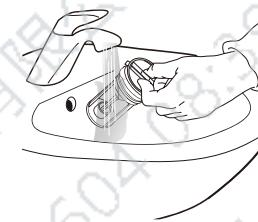
3. 排残水：逆时针转动滤网，而不用拆开滤网，并缓慢打开直至排走全部水。当该容器盛满水，将滤网按顺时针方向转紧。清空容器，重复这个步骤，直到水全部流出。
